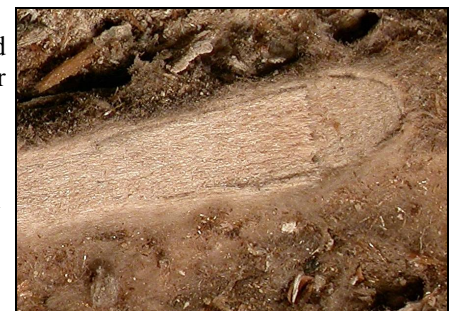
Abb. 14: Strang-Anschnitt des Echten Hausschwammes; ca. 3 mm breit
