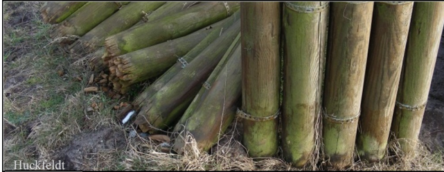
Abb. 13: Nadelholz-Palisade im Erdkontakt – Lebenserwartung ist kurz.
