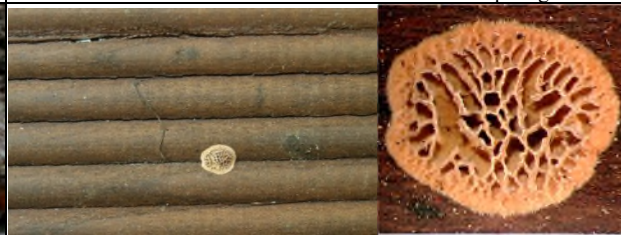
Abb. 4: Übersicht: 6 mm breiter Fruchtkörper eines Balkenblättlings ( Gloeophyllum trabeum ) an einer Thermo-Buchen-Diele mit einem finalen Braunfäule-Schaden (nach ca. 4,5 Jahren).
