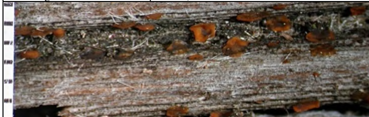
Abb. 3: Terrassen-Dielen-Detail mit Splintholz: eingetrocknete Gallertränen-Fruchtkörper. Unter optimierten Bedingungen im Labor erreicht z. B. die Bewurzelte Gallerträne an Douglasie 26,6 % Masseverlust in 12 Wochen¹.
